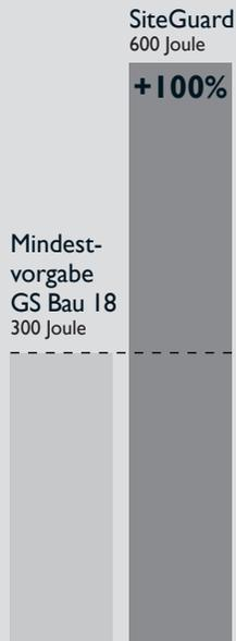
*In Belastungstests hielt der SiteGuard der doppelten Belastung (600 Joule) der geforderten Aufprallenergie der GS Bau 18 stand*
