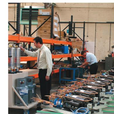
Alle Geräte werden auf Funktionstüchtigkeit kontrolliert, tiefvakuiert, mit 38 bar auf Druck getestet sowie einer Leckagedetektion mit Helium und einem einstündigen Probetest im Werk unter schwersten Belastungen unterzogen.
